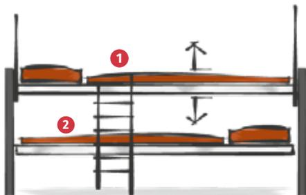
1 Das elektrische Hubbett ist sowohl in der unteren Position als auch in der Mittelposition unter Verwendung der Leiter nutzbar.
