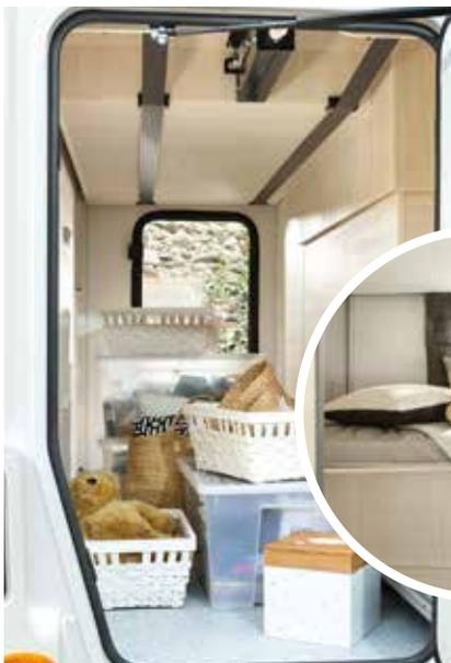
• **Von außen** einfache Höhenverstellung der Garage für die Unterbringung von Fahrrädern.
